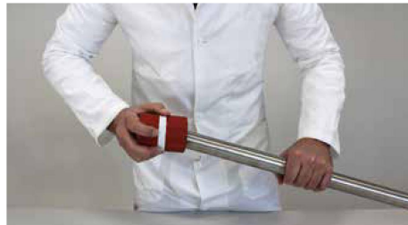
Entgraten des Leitungsrohres
